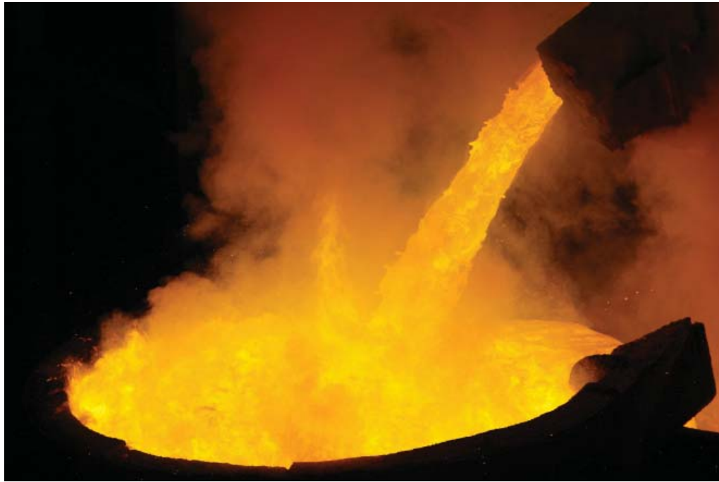
Tappning av råstål från ljusbågsugn till skänk i Sandviken.
