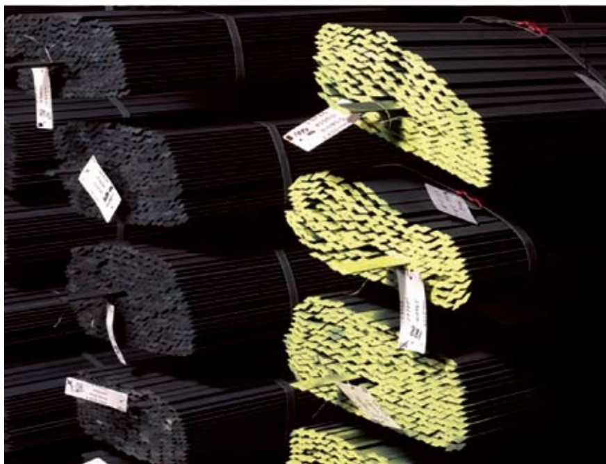
Valsade knivprofiler till t ex flishuggar i massabruk från Scana Steel Söderfors.
