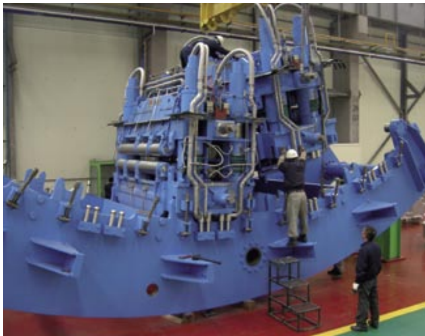
Avesta Works. Ny gjutbåge i stränggjutningsanläggningen i stålverket.
