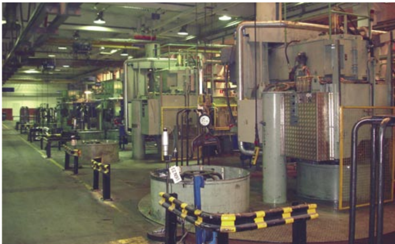
Haldex Garphyttan Wire. Ny skalkmaskin för valstråd som ökar kapaciteten för skalad ventilfjädertråd i Garphyttan med 33 procent.
