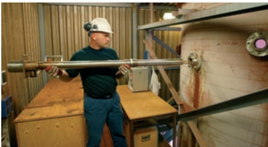
Provtagning av luft och stoft. SSAB Tunnlåda, Borlänge.
