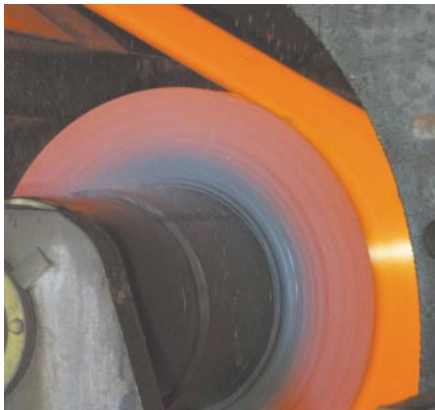
Haspel i steckelverket för varmvalsade rostfria coils i Avesta.
