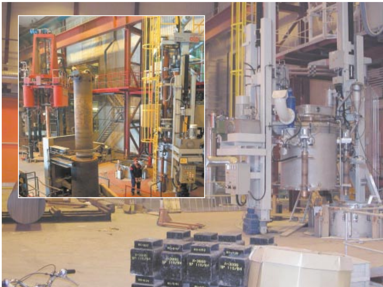
Elektroslaggomsmältningsugn hos Uddeholm Tooling.
