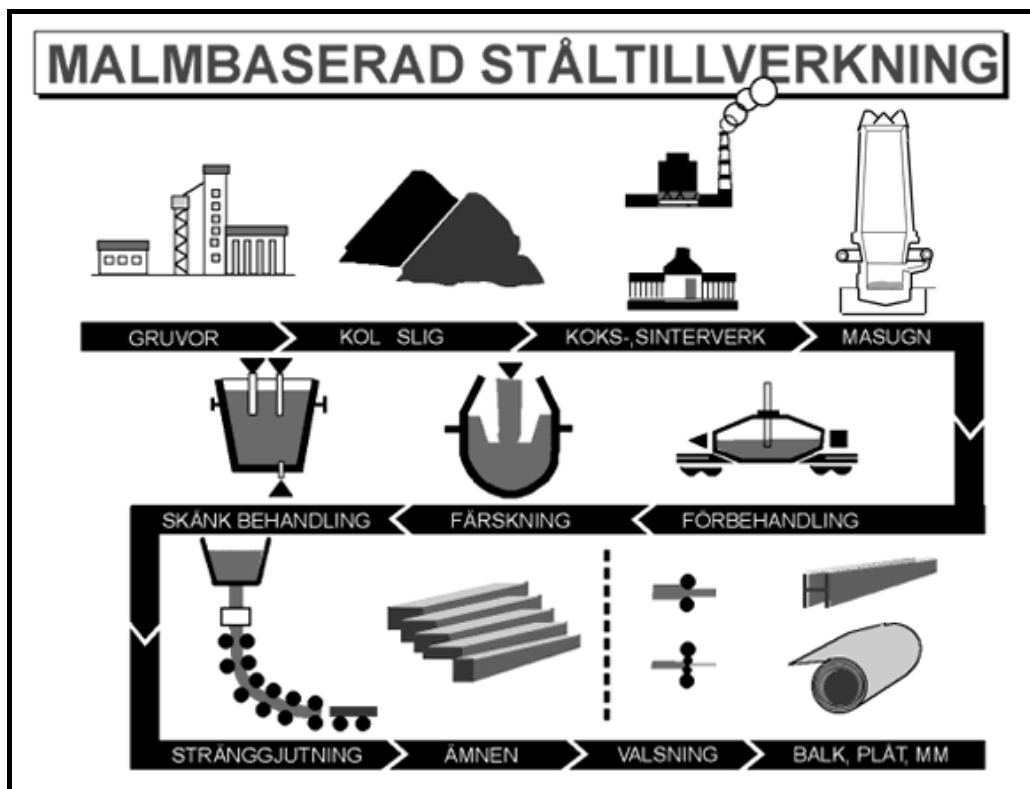
Figur 1 Schematiska flöden för malmbaserad ståltillverkning
