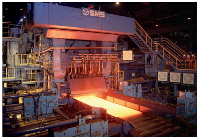
Sänkt ämnestemperatur spar energi och utsläpp av koldioxid.
