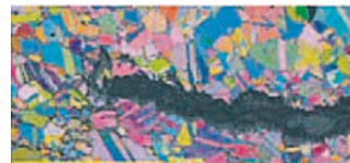
Kornstruktur kring spricka i rostfritt stål.
