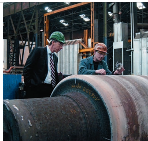
Ett stort engagemang genomsyrar Åkers kvalitetskontroll av valsar. Ett viktigt moment som ställer höga krav på gedigen kompetens och lång erfarenhet av valstillverkning.
