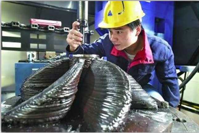
Figur 2. Ett exempel på DED metodik för tillverkning av en propeller som förberedes för skärande bearbetning till önskad geometri. Kombinationen av DED och skärande bearbetning kan ge stora fördelar i tillverkningen av stora komponenter 4 .
