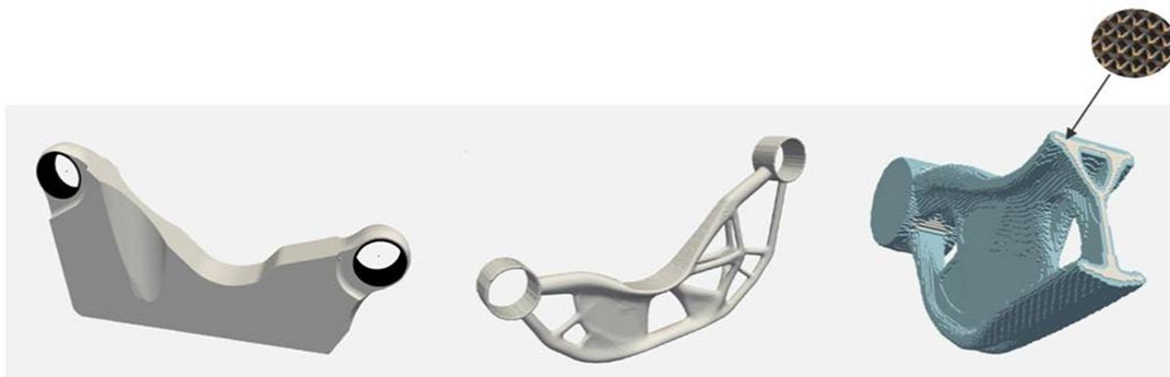
Figur 2. State-of-the-art topologioptimering av en konstruktionskomponent (med tillstånd från Volvo Cars)
