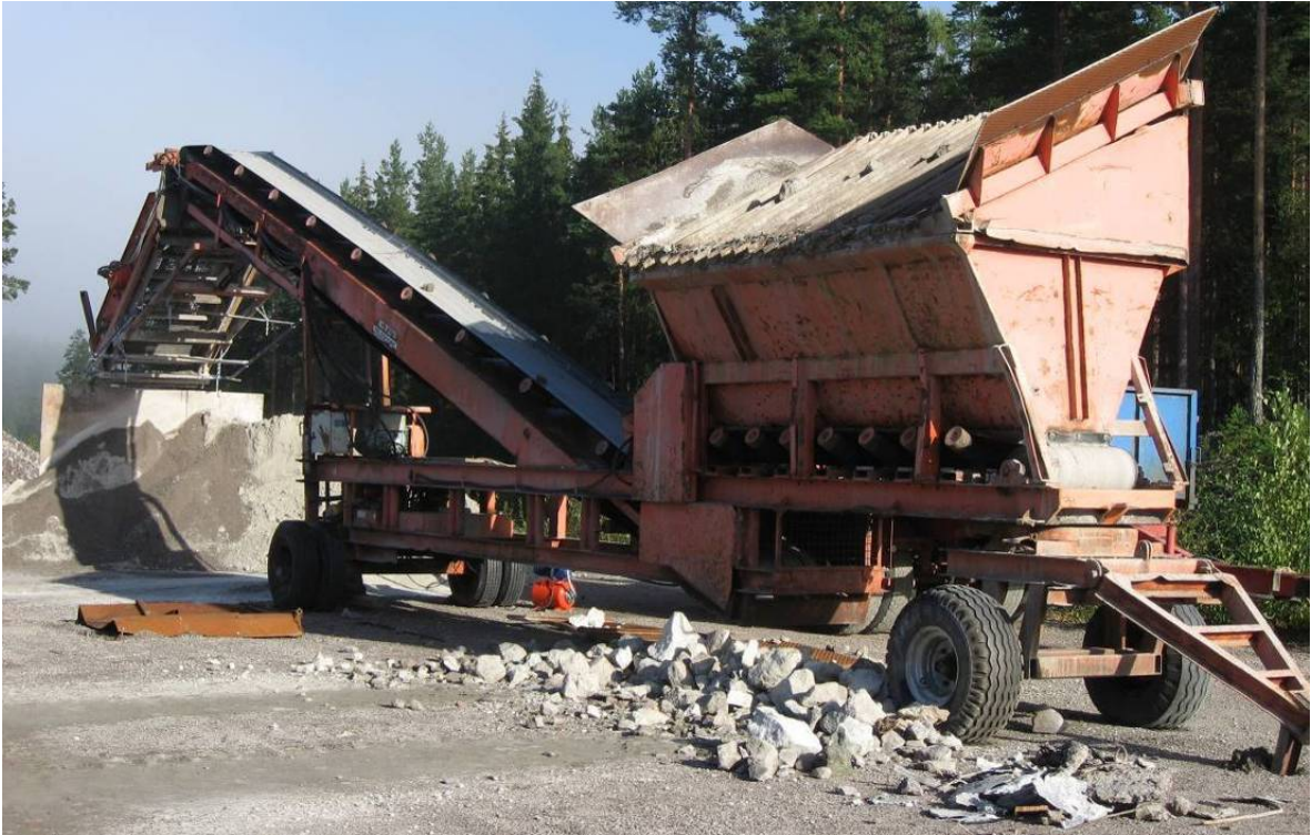
Figur 14 Utrustning för siktning och inblandning av vatten vid krossverket (2006). Stora bitar sorterades bort vid gallret till höger och efter bandet sorteras slaggarna i fin och grov fraktion. Vatten tillsätts till den fina fraktionen medan den faller ner på marken. Efter att skänkslaggen har börjat lagras under tak har det inte förekommit en sådan grov fraktion i materialet.
