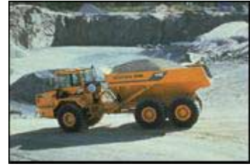
Figur 30 En dumper tillverkad av kallformningsstål. Källa: SSAB Oxelösund, Oxelösund
