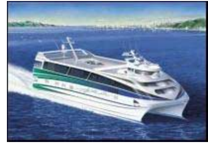
Figur 56 Båtskrov tillverkas ofta av Al 5xxx p.g.a. dess korrosionsegenskaper. Källa: Svenskt Aluminium, Stockholm
