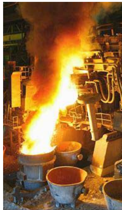
Figur 11 Tappning av råstål från ljusbågsugn till skänk.
