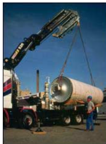
Figur 28 En lyftkrans arm tillverkat i seghärdat stål. Källa: SSAB Oxelösund, Oxelösund
