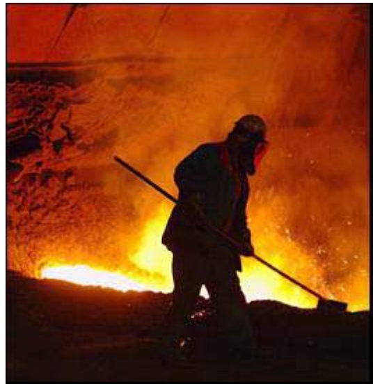
Figur 10. Slaggavskiljning vid masugn. Källa: SSAB Oxelösund AB, Oxelösund Foto: Stig-Göran Nilsson (2002)
