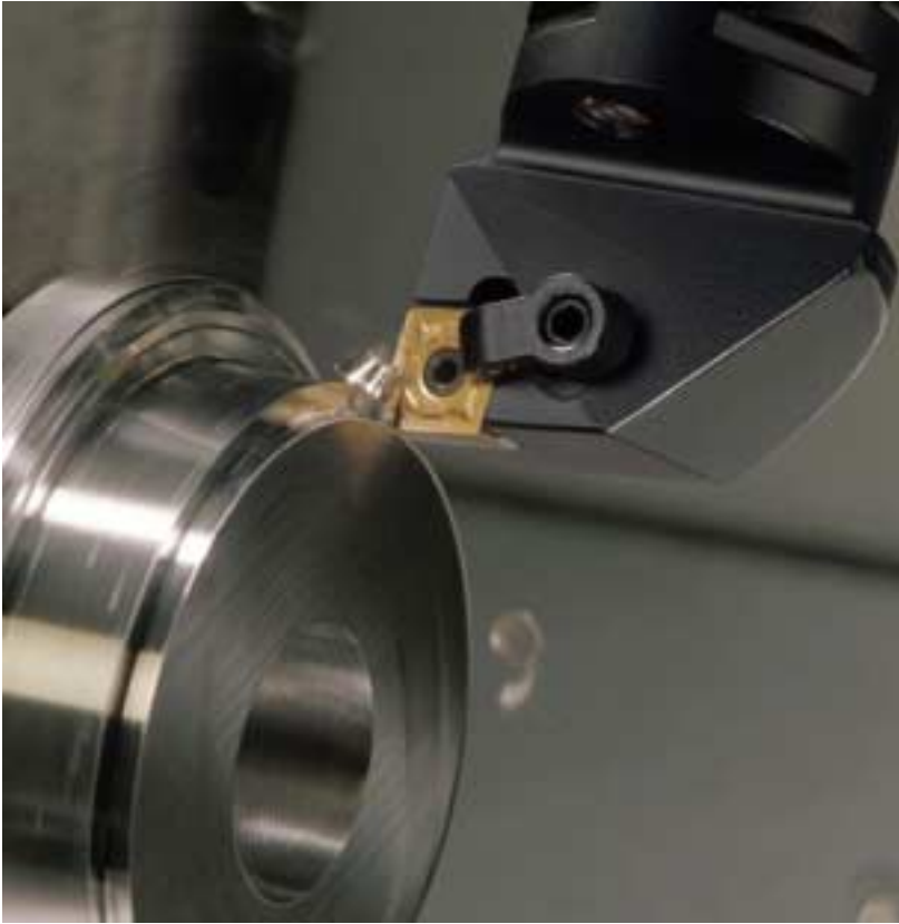
Skärverktyg i volfram-kobolt-karbid, sk. hårdmetallskär.
