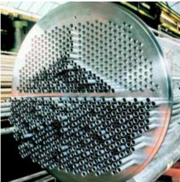
Molybdenlegerade rostfria rör i värmeväxlare (under tillverkning).
