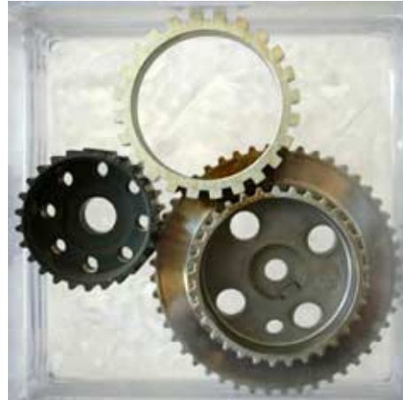
Järnpulver och kugghjul tillverkade av järnpulver.
