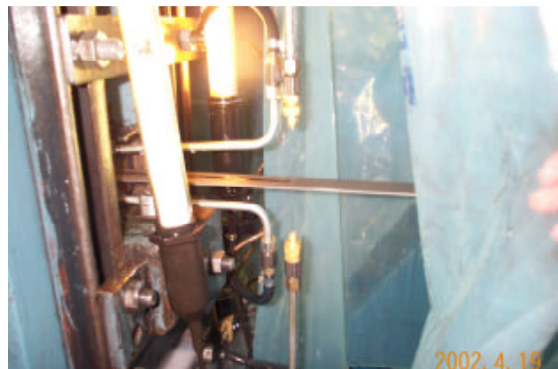
Fig 3. Dysornas placering som försmörjning och smörjning i valsgap.
