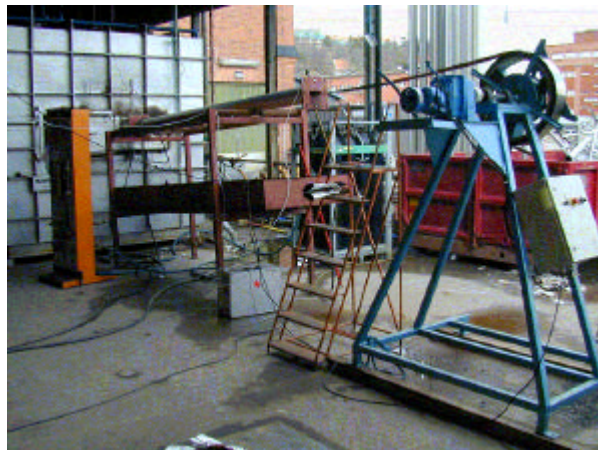
Fig.1. Detaljer av bandmatningssystemet för pilot glödgningen på AGA AB. Vänstra bilden visar inloppet till ugnen och den högra ugnsutloppet med tillhörande kylzon
