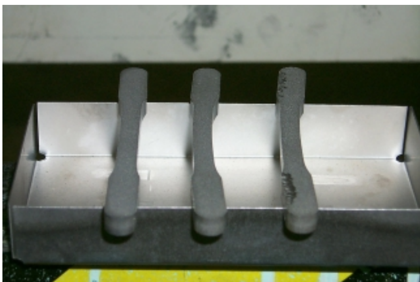
Bild 10 Exempel på böjda TS-provstavar, den till vänster är bra.
