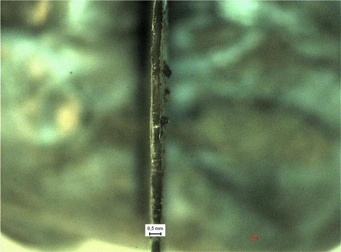
Figure 41. Cross section of slag film just below the slag rim.
