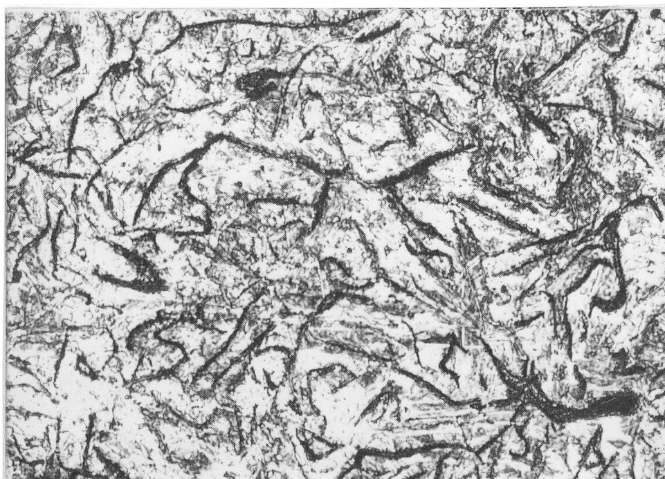
FIGUR 38. Prov 40. Grått tackjärn med mörkgrå grafitfjäll i en grundmassa av perlit. 200 x. Sample 40. Grey pig-iron with dark grey graphite lamellae in a matrix of pearlite. 200 x.
