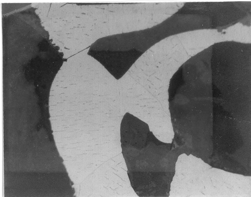
FIGUR 29. Prov 13. Delförstoring av fig 28. Ferrit och tro- ligen järnnitridnålar i ljust område. 500x. Enlargement of above, showing ferrite with nitride(?) needles. 500x.
