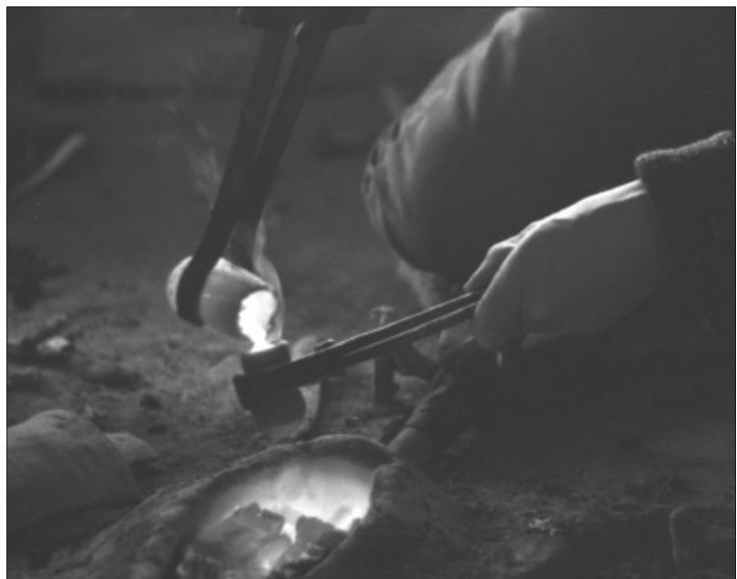
Figur 2. Smyckegjutning i kopparlegering enligt rekonstruerad vikingatida metod, med form och degel i keramiska material. Med blästerdrag från en bälg forceras temperaturen i träkolsbården till ca. 1200° C.
