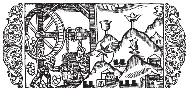
Figur 9. Ur Olaus Magnus "Historia om de nordiska folken" 1555, sjätte boken, 4:e och 5:e kapitlen. Hissverk uppfordrar den brutna malmen.
