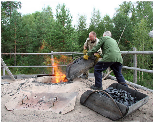
Masugnen i Nya Lapphyttan fylls på med kol. Bilden är från ett lyckat järnframställningsförsök under sommaren 2012. Bildkälla: www.nyalapphyttan.se .
