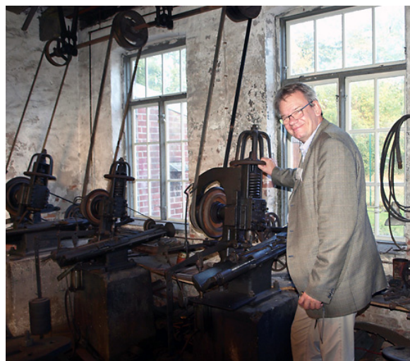
Gert Magnusson passade på att studera en filhuggningsmaskin under det bergshistoriska höstmötets exkursion till filfabriken i Hässleholm. Foto: Anders Ödman.
