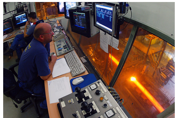
Kontrollrum för skärstationen där det stränggjutna stålet skärs till lagom långa ämnen. Foto: Stig-Göran Nilsson.
