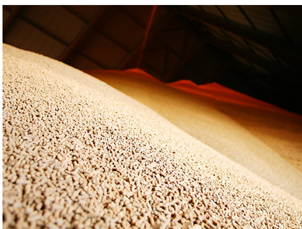
Ett stort antal företag deltar i förstudien "Förnybar energi i värmningsugnar", som undersöker effekter av biobränsleanvändning. Bilden visar barkpellets. Foto: Södra/Jesper Andersson.
