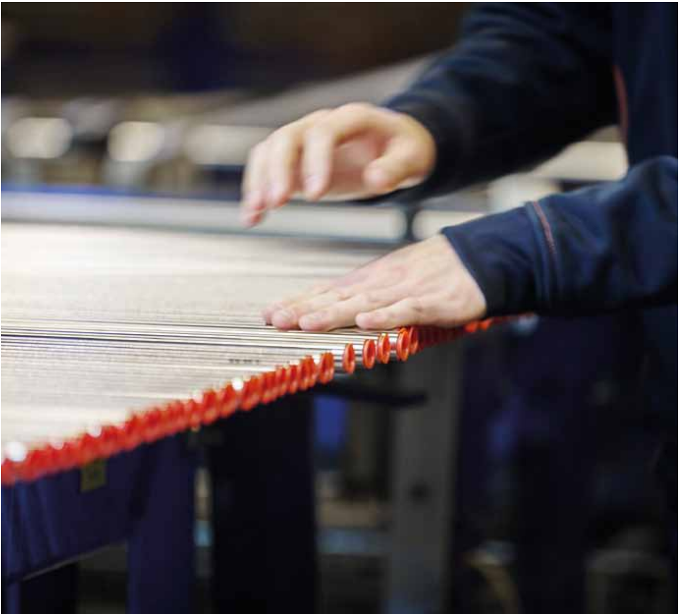
Förberedelse inför ultraljudsprovning av rör. AB Sandvik Materials Technology.
