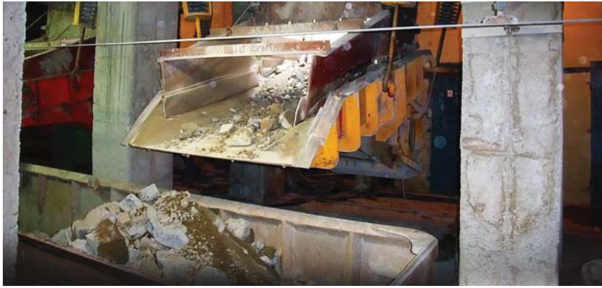
Figur 3.12. Exempel på en transportrännna använd i gruvor där livslängden kan ändras genom användning av så kallat slitstål.
